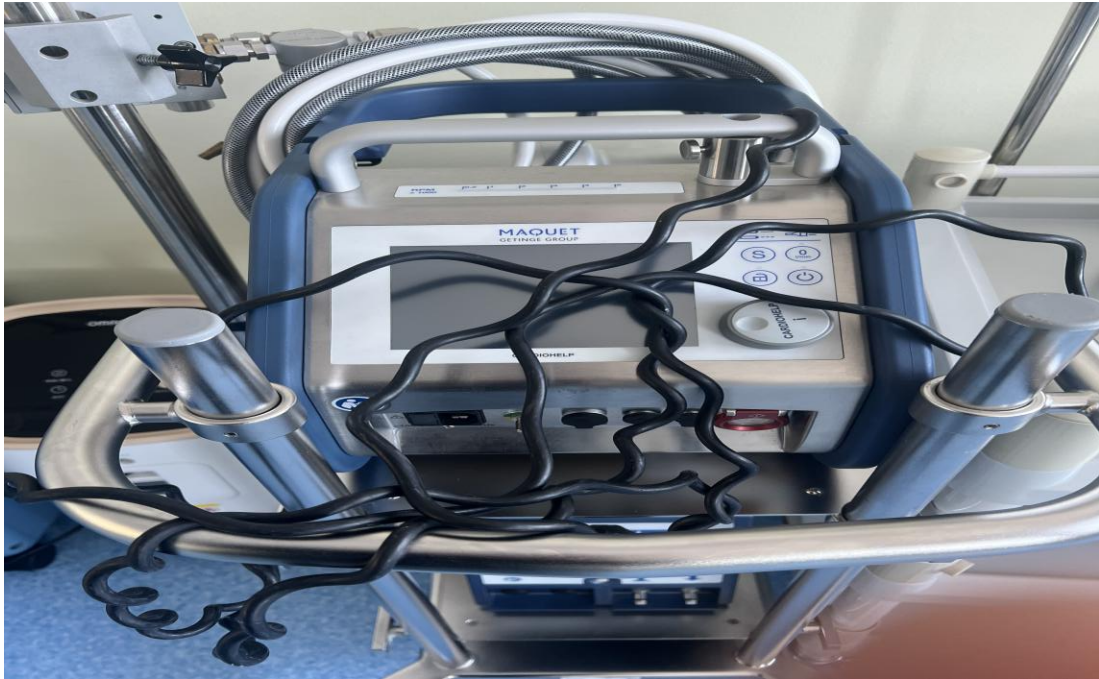
Cardiohelp буюу зөөврийн ЕСМО зүрх болон уушигны үйл ажиллагааг гадна төхөөрөмжөөр орон дэмжих аппарат
